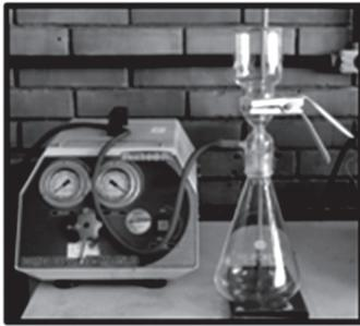
FIGURA 4. Sistema de filtração a vácuo para ensaio de dessalinização.
