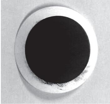
FIGURA 3. Membrana de filtração contendo o filme de GO ao centro.
